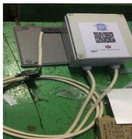
Gambar 7 adalah komponen-komponen yang sudah dirangkai sesuai dengan diagram skematik yang sudah menjadi alat smart power monitoring.
