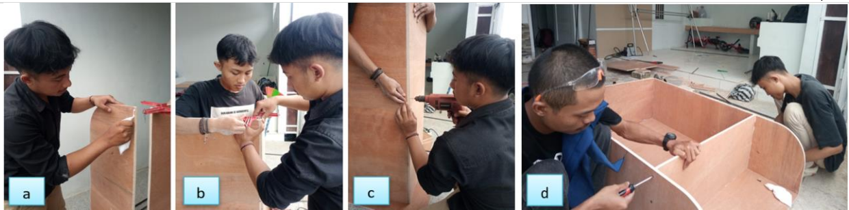
Gambar 6. Perakitan lemari yang terdiri dari pengeleman (6a), penyambungan dengan klem (6b), dan pengeboran (6c), dan penyekrupan (6d)
