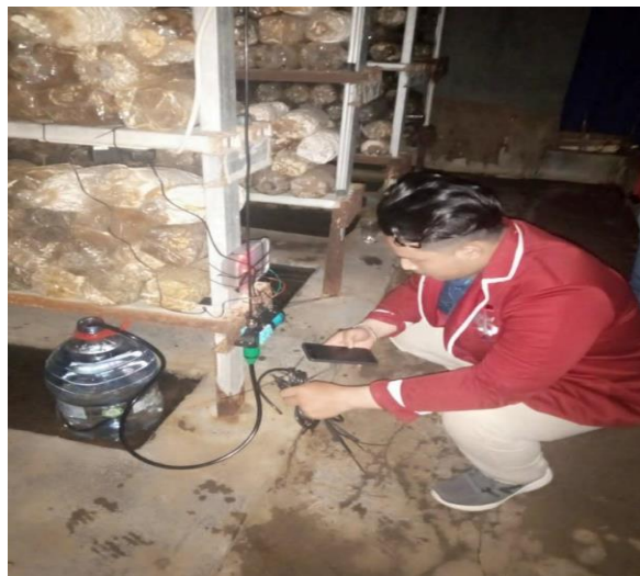
Gambar 5. Alat sistem penyiraman otomatis yang dipasang di dalam rumah kumbung jamur.
